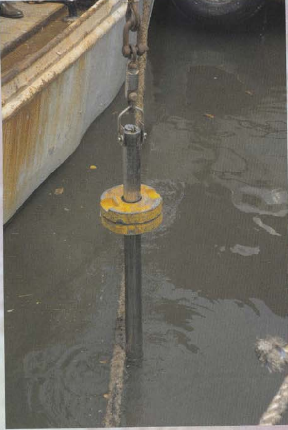
चित्र-4. विशेष कोर लाइनर का 'सागर सुक्ति' अनुसंधान पोत पर परीक्षण
