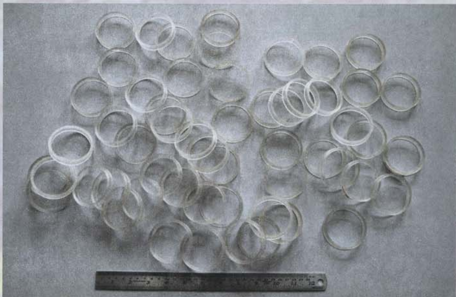
चित्र-1. एक्रिलिक लाइनर से बनें 1 सेंटीमीटर आकार के एक जैसे छल्ले
